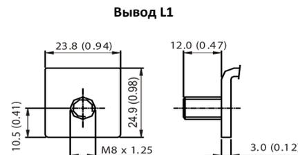
Усилие затяжки: L1 (10Nm±5%)
